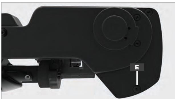
Localisez la vis (F) à l'avant de l'**unité de tête d'affûteur** et démontez-la avec la clé Torx T25 incluse. Répétez avec le côté opposé.
