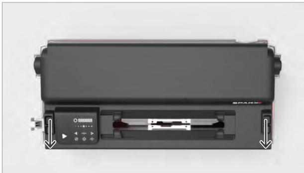
Сдвинув защелки вниз, поднимите головку устройства.
