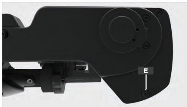
Suchen Sie die Schraube (F) an der Vorderseite der **Kopfeinheit der Schleifmaschine** und entfernen Sie sie mit dem mitgelieferten Torx-T25-Schlüssel. Auf der anderen Seite wiederholen.
