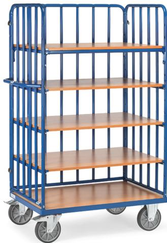
Baukasten-System: Aus Stahlrohr und Profilstahl geschweißt, pulverbeschichtet blau RAL 5007, Schraubkonstruktion. Stirnwände mit vertikalen Rohrstreben im Abstand von 130 mm. 1 Längswand mit Rohrstreben zum Einhängen. 1 fester und 4 lose Einlegeböden aus Holzwerkstoffplatten, Oberfläche Buchendekor. Einlegeböden variabel einsetzbar, Teilung 100 mm. Tragkraft pro Einlegeboden 90 kg. 2 Lenk- und 2 Bockrollen, TPE-Bereifung, Naben mit Rillenkugellager. Feststeller an den Lenkrollen.
