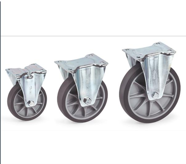
Gehäuse Stahlblech verzinkt. Räder mit TPE-Bereifung (thermoplastisches Elastomer). Kunststoff-Felgen, Naben mit Rillenkugellager und Fadenschutz. Sehr geringer Anfahr-, Roll- und Schwenkwiderstand. Reifen nicht kreidend (spurlos).
