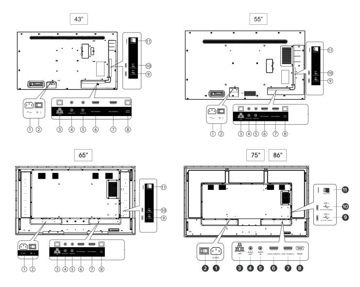
1) AC IN - 2) Main Power Switch - 3) LAN - 4) Audio OUT - 5) Audio IN - 6) HDMI2 IN 7 HDMI1 IN - 8 RS232 - 9 USB Port 2 - 10 USB Port 1 - 11 Micro SD
