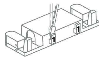
3 Inserte la manguera de conexión a red en la caja de conexiones.
