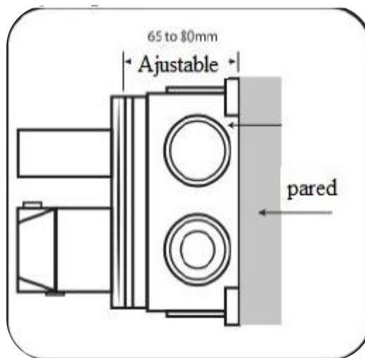
**Paso 2:** Conecte el suministro y salida de agua. Atornille el conjunto del mezclador de ducha en su lugar. **PRUEBE Y REVISE POR FUGAS**
