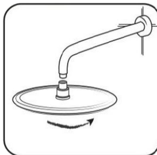
**Paso 6:** Instale la pared de la ducha y el dispositivo de mano
