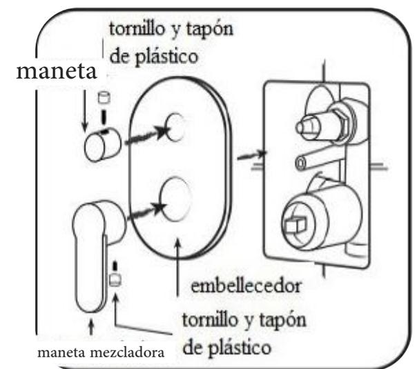
**Paso 4:** Instale en el tubo de la pared
