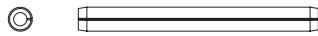
#2 - (1) M3 DIA X 32mm GATE PIN (1) GOUPILLE DE BARRIÈRE M3 DIA X 32 mm (1) PERNO DE LA PUERTA M3 DIA X 32MM
