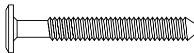
U. M6 x 50 mm Bolt x 2 Boulon M6 x 50 mm x 2 Perno M6 x 50mm x 2
