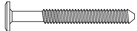
LL. M6 x 55 mm Bolt x 2 Boulon M6 x 55 mm x 2 Perno M6 x 55mm x 2
