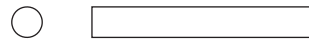
#21 - (10) \Phi 4 x 30mm Metal Pin (10) \Phi 4 x 30mm Goujon de métal (10) \Phi 4 x 30mm Espiga de Metal 5493
