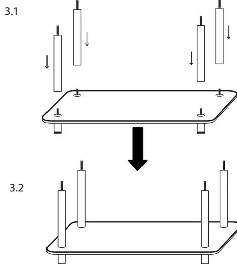
2.- Coloca la primera balda de base. Pasando los tornillos de las patas por lo agujeros de la balda.
