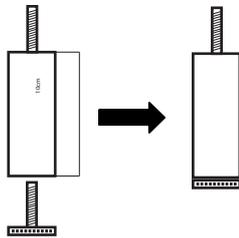
3.- Enrosca los soportes intermedios según tu composición. Fijalo de manera que quede totalmente enroscado.
