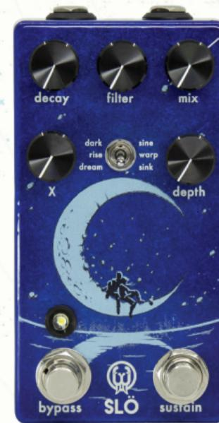
**ALGORITHM-SCHALTER** – Mit dem Schalter wird einer von drei verfügbaren Hall-Algorithmen ausgewählt. **Zweite Funktion:** Auswahl der Wellenform zur Modulation.
