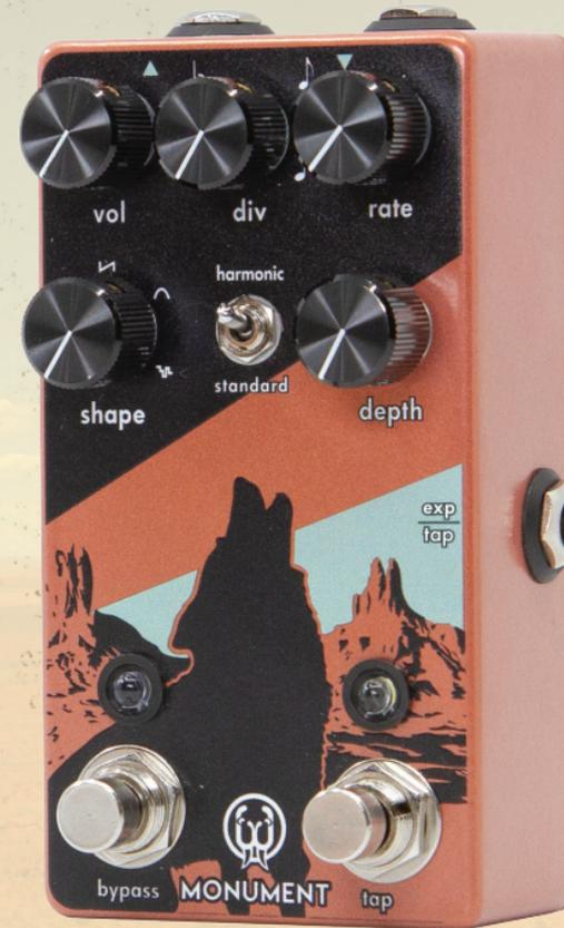
**ENTRÉE JACK EXPRESSION/TAP** - Contrôlez les paramètres avec une pédale d'expression TRS standard ou ajustez la vitesse du tremolo avec une pédale Tap externe. Pour passer de Tap à Exp, ouvrez la plaque arrière et bougez le cavalier de bobine situé en bas à droite de la carte de circuit imprimé sur TAP ou EXP.
