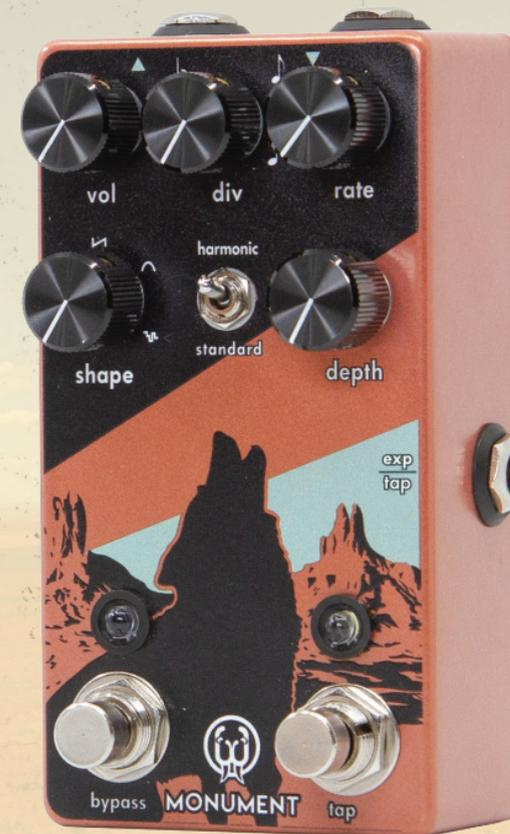
**ENTRADA EXPRESSION/TAP** - Controla parámetros con un pedal de expresión estándar con conector TRS o ajusta el ritmo del tremolo con un interruptor tap opcional. Para cambiar entre tap y pedal de expresión, abre la placa posterior y mueve el puente en la parte inferior derecha de la placa PCB a la posición TAP o EXP.
