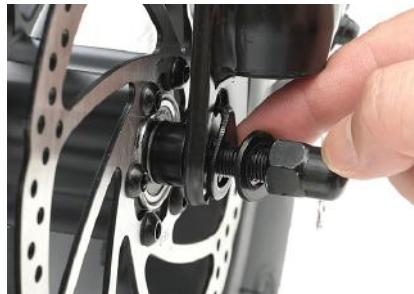
27 Serrez les écrous des deux côtés du roulement
