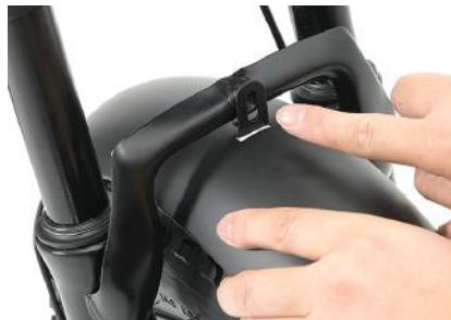
30 Serrez les vis pour fixer le garde-boue au support de fourche
