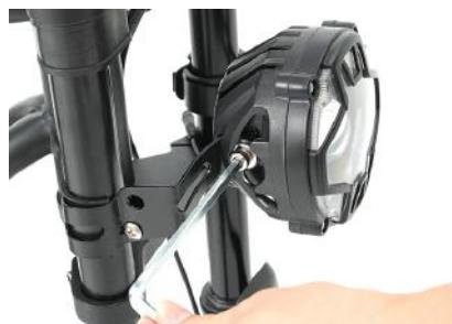
**18** Alignez les flèches sur les connecteurs etenfoncez pour brancher le câblage du phare
