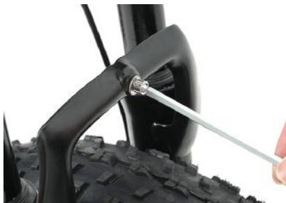
29 Wyrównaj otwory błoñnika z otworami mocowania widelca
