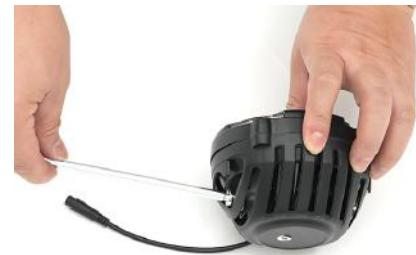
**16** Alignez les trous de fixation du phare avec les orifices des deux côtés du support
