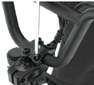
**13** Serrez les vis des deux leviers de frein pour les fixer solidement
