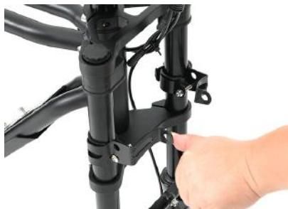
15 Wyjmij dwie boczne ruby z o budowy reflektora
