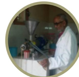
La pression à vis à la seule force mécanique (sans solvant) et à froid (sans chauffage)
