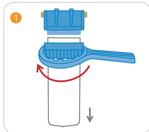
1 Svitare la parte inferiore dell'involucro del filtro con la chiave dalla testa dell'involucro.
