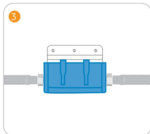
3 Fissare il sistema così preassemblato sul muro e integrarlo con il tubo dell'acqua fredda. Per fare questo, stringere i dadi di raccordo del tubo flessibile di collegamento supplementare alla valvola ad angolo e l'ingresso della testa dell'alloggio (IN). Ora collegare il dado di raccordo del tubo flessibile (rubinetto) all'uscita della testa dell'alloggio (OUT).
