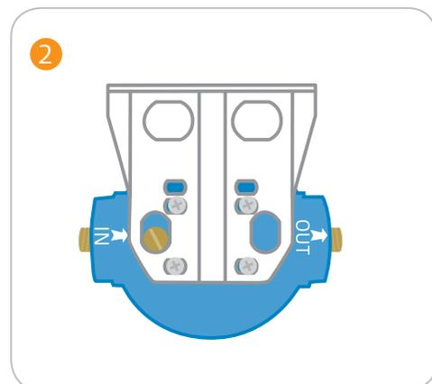
2 Avvitare il supporto a parete alla testa dell'involucro del filtro utilizzando le 4 viti piatte in acciaio inox.
