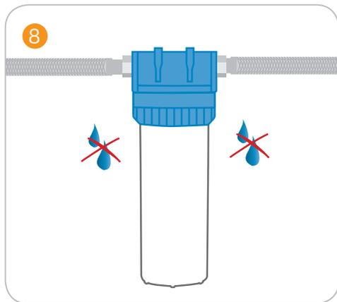
Die Leitung durch Öffnen des Wasserhahns weiter entlüften.
