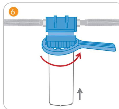
6 Relier la partie inférieure du boîtier et la cartouche avec la tête du boîtier et serrez-la avec la clé pour boîtier. Veiller à la bonne assise des joints d'étanchéité.
