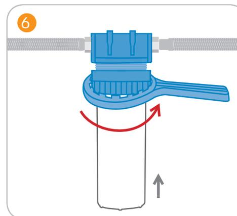
Gehäuseunterteil inklusive Kartusche wieder mit dem Gehäusekopf verbinden und mit Gehäuseschlüssel festziehen. Auf den Sitz der Dichtungsringe achten.
