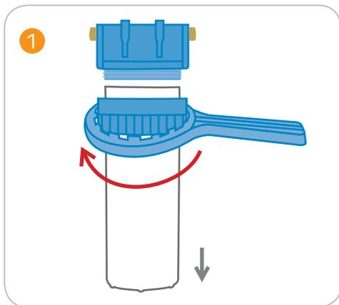
Das Unterteil des Filtergehäuses mit dem Gehäuseschlüssel von dem Gehäusekopf abschrauben.
