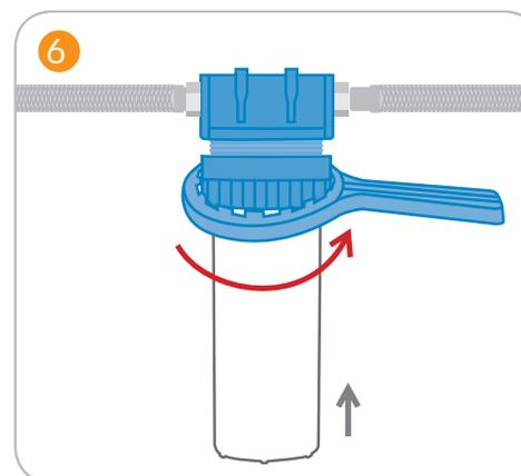
6 Collegare la parte inferiore dell'alloggio incluso la cartuccia filtrante con la testa dell'alloggio utilizzando la chiave come da immagine. Controllare la tenuta corretta degli anelli di guarnizione.
