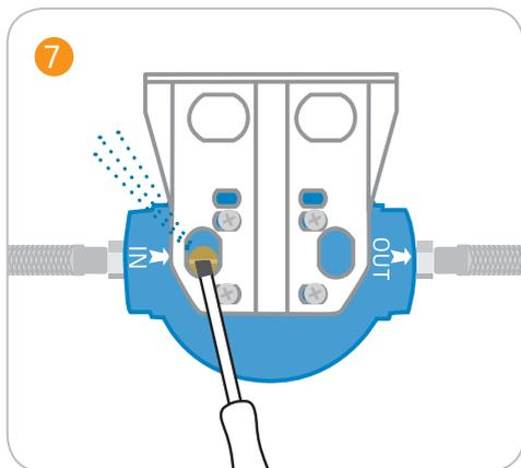
Immerger le système à filtre dans de l'eau en ouvrant le robinet équerre.
