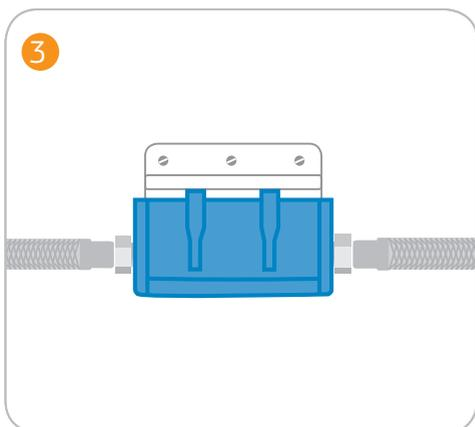
Das somit vormontierte System an der Wand befestigen und in die Kaltwasser-Rohrleitung einbinden. Schließen Sie dazu die Überwurfmutter des zusätzlichen Flex-Verbindungsschlauches an das Eckventil und den Eingang des Gehäusekopfes (IN) an. Schließen Sie nun die Überwurfmutter des gelösten Flexschlauches (Armatur) an den Ausgang der Gehäusekopfes (OUT) an.
