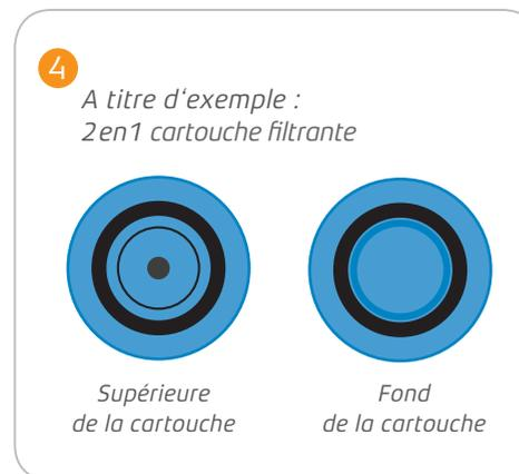
4 Déterminer la partie supérieure de la cartouche avant d'insérer la cartouche filtrante.
