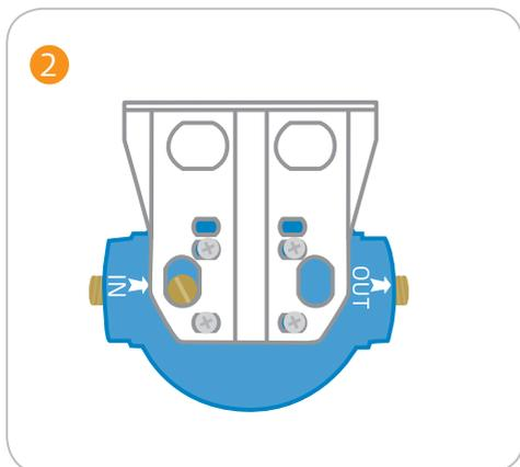
Wandhalterung an den Filtergehäusekopf mit den 4 flachen Edelstahlschrauben aufschrauben.
