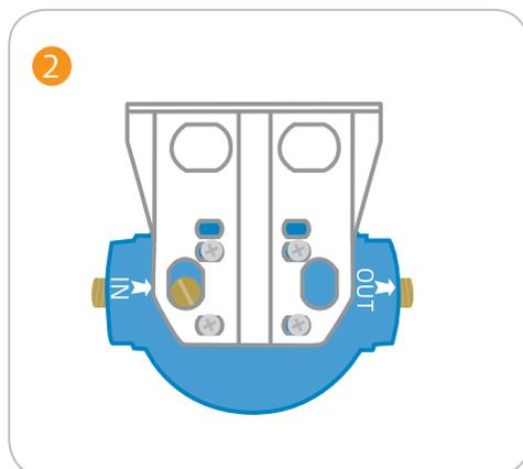
2 Vissez les supports muraux sur les têtes des boîtiers des filtres à l'aide des 4 vis en acier inoxydable.
