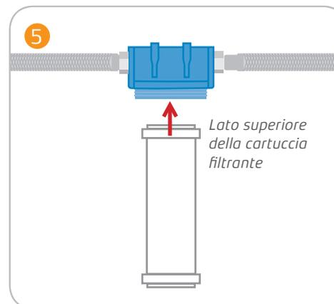
5 Inserire la cartuccia filtrante, con il lato superiore nella testa dell'alloggio.
