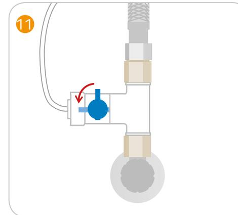
Öffnen Sie nun den Wasserzulauf am T-Adapter. (Hebelstellung in Schlauchrichtung).
