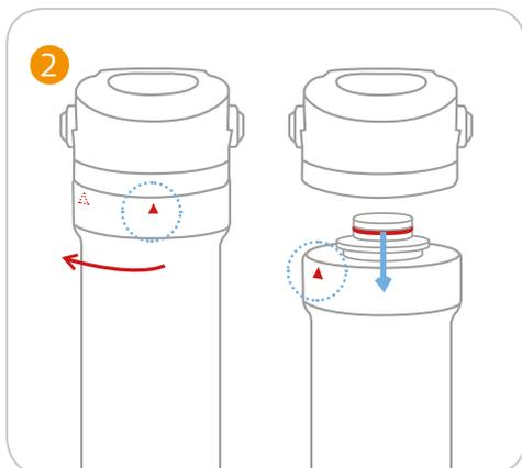
Die Filterpatrone eine 1/4-Drehung nach links drehen und nach unten herausziehen. Auf der Filterpatrone ist ein Pfeil der Ihnen bei der richtigen Positionierung hilft.
