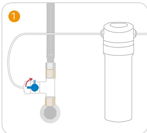
Den Wasserzulauf am T-Adapter schließen.
