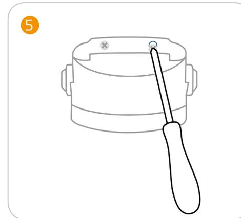
Der Filterkopf wird mit zwei Schrauben unter der Spüle an geeigneter Stelle an die Wand oder die Seitenwand des Unterschranks ihrer Einbauküche geschraubt. **Berücksichtigen Sie dabei die vorhandene Schlauchlänge des Zulauf- und des Filterwasserschlauchs.**
