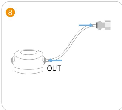
Zum Kürzen der Schläuche, ist unbedingt ein geeignetes Werkzeug zu verwenden. Der Schlauch darf nicht mit einer Standardzange oder Seitenschneider gekürzt werden.
