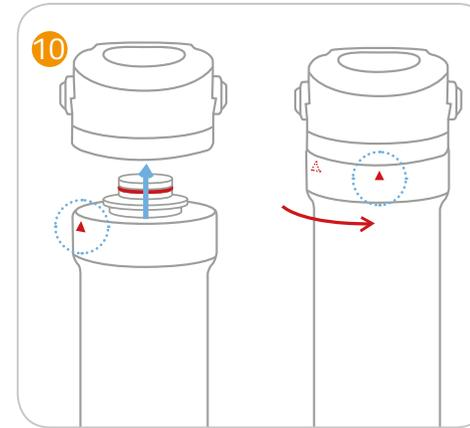
Auf der Filterpatrone ist ein Pfeil der Ihnen bei der richtigen Positionierung hilft. Die Kartusche mit dem Pfeil nach Links ausgerichtet (Seite Wasserzulauf) von unten in den Kopf einführen. Dann die Filterpatrone mit einer 1/4 Drehung nach rechts drehen bis zum Anschlag. Der Pfeil steht jetzt vorne in der Mitte vom Filterkopf.
