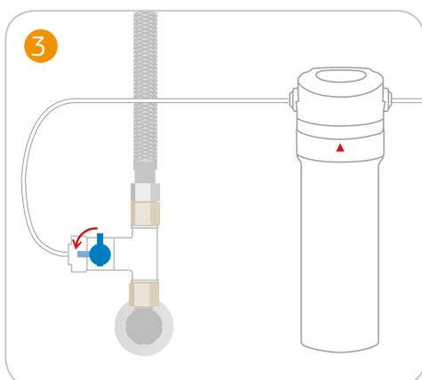
Die neue Filterpatrone einsetzen und mit einer 1/4-Drehung nach rechts drehen bis zum Anschlag.
