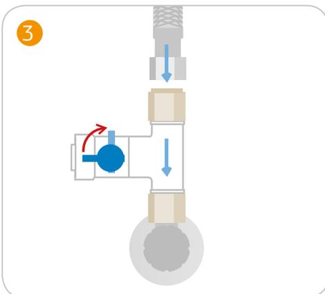
Schrauben Sie an das 3/8" Gewinde des Eckhahnes den T-Adapter an. Dann verbinden Sie den 3/8" Schlauch der vorhandenen Spülarmatur mit dem 3/8" Anschluss des T-Adapters.
