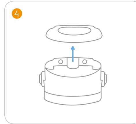
Mit einem Schlitzschraubenzieher können Sie vorsichtig den Deckel des Filterkopfes abheben. Dadurch werden die Löcher für die Halteschrauben sichtbar und der Kopf lässt sich einfach an die Wand montieren.
