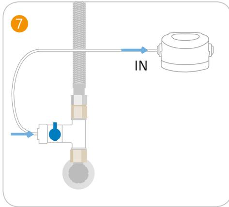
Nun wird der weiße Schlauch für den Wasserzulauf in die Wasserzulaufseite (siehe Pfeil auf Gehäuse) des Filterkopfs gesteckt. Danach das andere Ende in den T-Anschlußadapter stecken.
