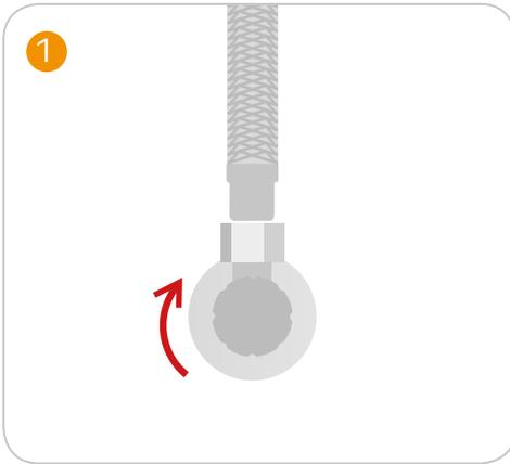
Drehen Sie den Wassereckhahn für Kaltwasser unter der Spüle ab, so dass der Wasserfluss unterbrochen wird.
