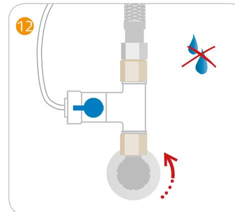
**Achtung:** Kommt irgendwo Wasser herausgeflossen, schließen Sie das Eckventil sofort und dichten die Stellen ab, z. B.: durch nachziehen der Verbindungen und indem die Schläuche fester bis zum Anschlag in die Öffnungen gedrückt werden. Führen Sie diesen Schritt solange fort, bis keine Undichtigkeit mehr festgestellt werden kann und öffnen den Wasseranschluß ganz.
