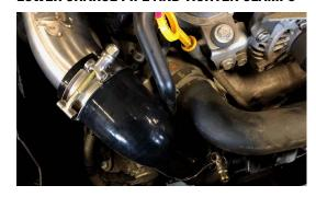
21. INSTALL UPPER CHARGE PIPE IN BETWEEN INTERCOOLER COUPLER AND EXPANDER COUPLER
