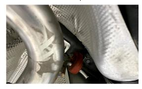
12. INSTALL SLIP ON TIPS, ORIENTAT AS PICTURED TIGHTEN 10MM CLAMP ONCE POSITION IS AS DESIRED.
