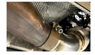
11. REINSTALL THE VBAND BACK ONTO THE TURBO OUTLET AND DOWNPIPE
