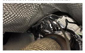
6. NOW YOU WILL BE ABLE TO ROTATE THE DOWNPIPE OFF THE STUDS OF THE BRACKET, ALLOWING YOU TO SLIP THE DOWNPIPE OUT
