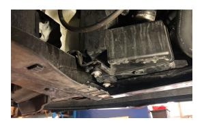
6. GIVE THE LOWER AIR BOX A FIRM TUG TO SEPARATE IT FROM THE UPPER AIR BOX
