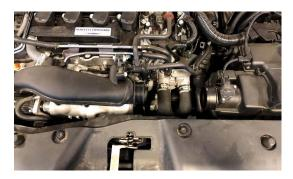
5A-B. NEXT YOU REMOVE THE 3 10MM BOLTS HOLDING THE DOWNPIPE HEAT SHIELD ON. ONE IS UNDER THE INTAKE TUBE AND THE OTHER 2 ARE LOWER DOWN IN THE FRONT. THEY SHOULD BE EASY TO SPOT, BUT WE WERE UNABLE TO GET A GOOD PICTURE OF THEM INSIDE THE CAR
