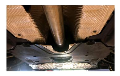
2A-C. REMOVE THE MUFFLER FROM THE RUBBER HANGERS, AND REMOVE THE MUFFLER
