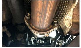
**10. START CAR AND CHECK FOR LEAKS** IF NO LEAKS REINSTALL FACTORY UNDERTRAY **REINSTALL OEM ENGINE COVER AND TURBO HEAT SHIELD IF EQUIPPED**
