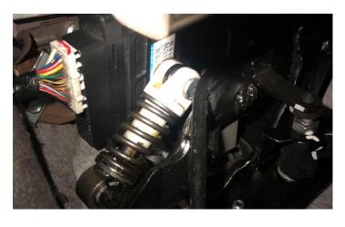
26. INSTALL SLAVE CYLINDER LINE WITH NEW BANJO BOLT AND TIGHTEN DOWN.
