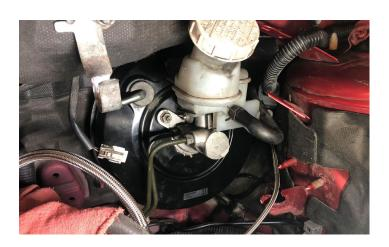
23. REINSTALL BRACKET FOR BATTERY TERMINAL, AND BOOST CONTROL SOLENOID.
