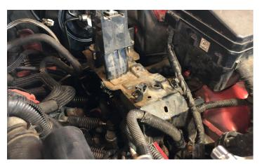
24. REINSTALL BOOST CONTROL SOLENOID AND PLUMB LINES BACK IN
