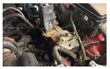
28. REINSTALL BOOST CONTROL SOLENOID AND PLUMB LINES BACK IN
