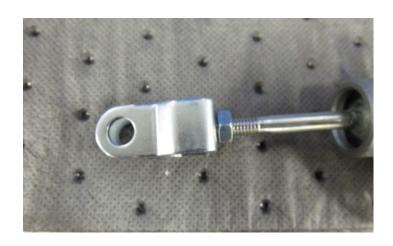
2A-C. REMOVE THE FACTORY M8 STUDS ON THE MASTER CYLINDER USING EITHER A STUD REMOVAL TOOL OR TWO M8X 1.25 NUTS. INSTALL THE CMC TO THE ADAPTER UTILIZING THE 2 SHORTER M8 SCREWS
