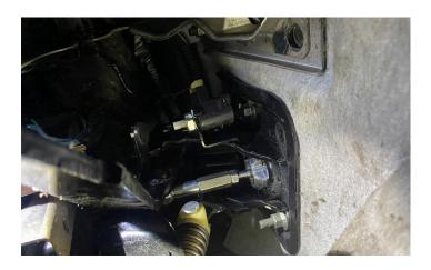
24. REINSTALL FIREWALL HEAT SHIELD, AND CLOCK SLAVE LINE AS PICTURED. TIGHTEN DOWN THE BANJO BOLT.
