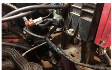
29. REINSTALL POSITIVE BATTERY CABLES AND TIGHTEN DOWN.
