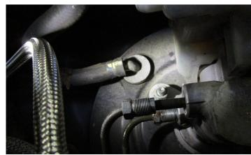
12. REMOVE CLUTCH MASTER FLUID FEED LINE FROM BRAKE MASTER CYLINDER.
