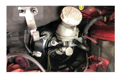
27. REINSTALL BRACKET FOR BATTERY TERMINAL, AND BOOST CONTROL SOLENOID.
