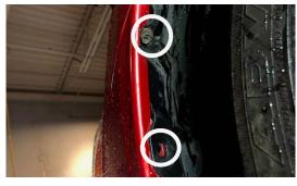
4. REMOVE CLIPS HOLDING BUMPER TO Undertray 5. GENTLY PULL BUMPER BUMPER FORWARD AND OFF, UNCLIP THE FOG LIGHT HARNESS FROM THE BUMPER
