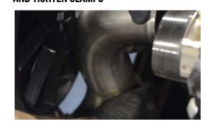
23. PLACE THE LOWER COUPLER ON THE DRIVERS SIDE, AND SLIDE IN THE INTERCOOLER PIPE. THEN PLACE THE UPPER COUPER ON THE PIPE AND ATTACH TO TURBO, TIGHTEN ALL CLAMPS.
