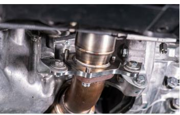
21. MOVE BACK UPTOP, REINSTALL YOUR INLET PIPE BACK ONTO THE TURBO, ENSURE THE GASKET IS IN PLACE
