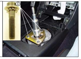
17. Reinstall shift linkage bolt.
