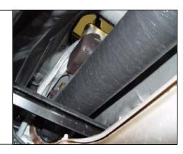
10. Remove shift linkage bolt.
