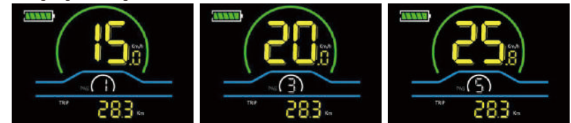
Schnittstelle zur Anzeige des PAS-Levels
