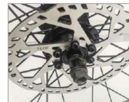
3. ajuste la posición de la tuerca
