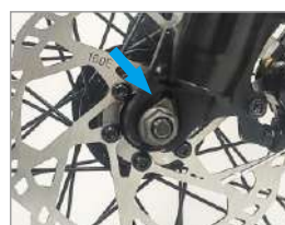
5. apriete las tuercas izquierda y derecha como se muestra en la imagen.
