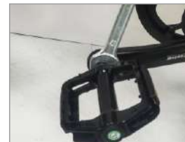
8. Nimm das Pedal mit den Buchstaben "R" und "L" heraus, richte es mit dem Kurbelloch aus und verriegele es mit einem Schraubenschlüssel
