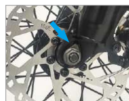
5. Serrer les écrous gauche et droite comme indiqué dans l'image
