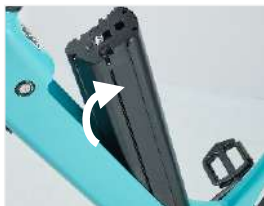
Rimuovere la batteria nella direzione della freccia
