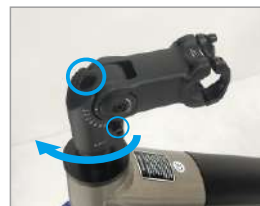
1. ajuste los tornillos superiores y laterales para que el tubo vertical gire hacia adelante
