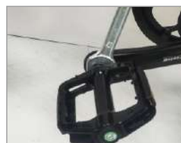
8. retire el pedal con las letras "R" y "L", alinéelo con el agujero de la manivela y bloquee con una llave inglesa
