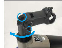
1. Stellen Sie die oberen und seitlichen Schrauben so ein, dass sich der Steiger gerade nach vorne dreht
