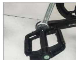
8. Retirez les pédales avec les lettres "R" et "L", Alignez - les avec le trou de manivelle et Verrouillez - les avec une clé
