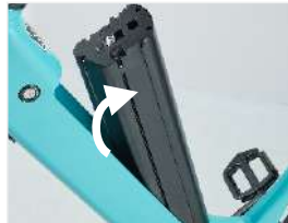
Retirer la batterie dans le sens de la flèche
