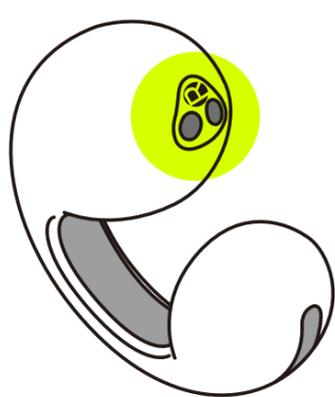
La presenza di corpi estranei o di umidità sui terminali degli auricolari o della custodia di ricarica può causare la corrosione dei terminali e impedire la ricarica.
