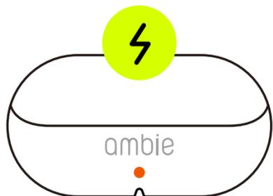
Il LED sulla custodia di ricarica indica lo stato di carica degli auricolari (se la custodia non è in carica).
