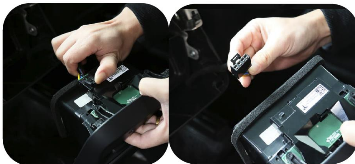
Figur 3: Koble fra USB-ladekabelens hurtigklemmer fra det originale luftuttaket/ventilene og fjern det fra bilen
