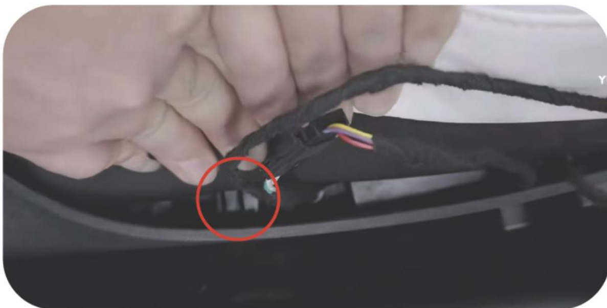
Figur 6: På baksiden av passasjeretet bruker du plastverktøyet for å løsne av setejusteringsplaten og trekker deretter ut pluggen. Så tar du å kobler til den grønne pluggen.
