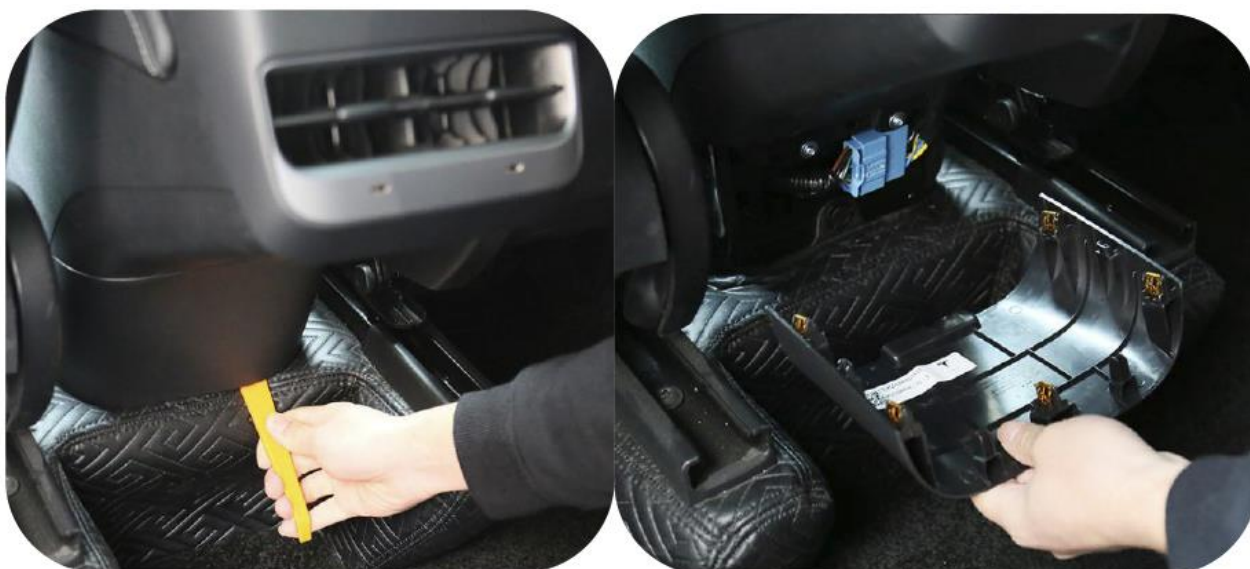
Figur 1: Bruk medfølgende plastverktøyet (oransje) for å lirke løst nedre plastdeksel på det bakre ventilasjonsuttaket. Plastdekselet er festes med klips som løsner med litt makt
