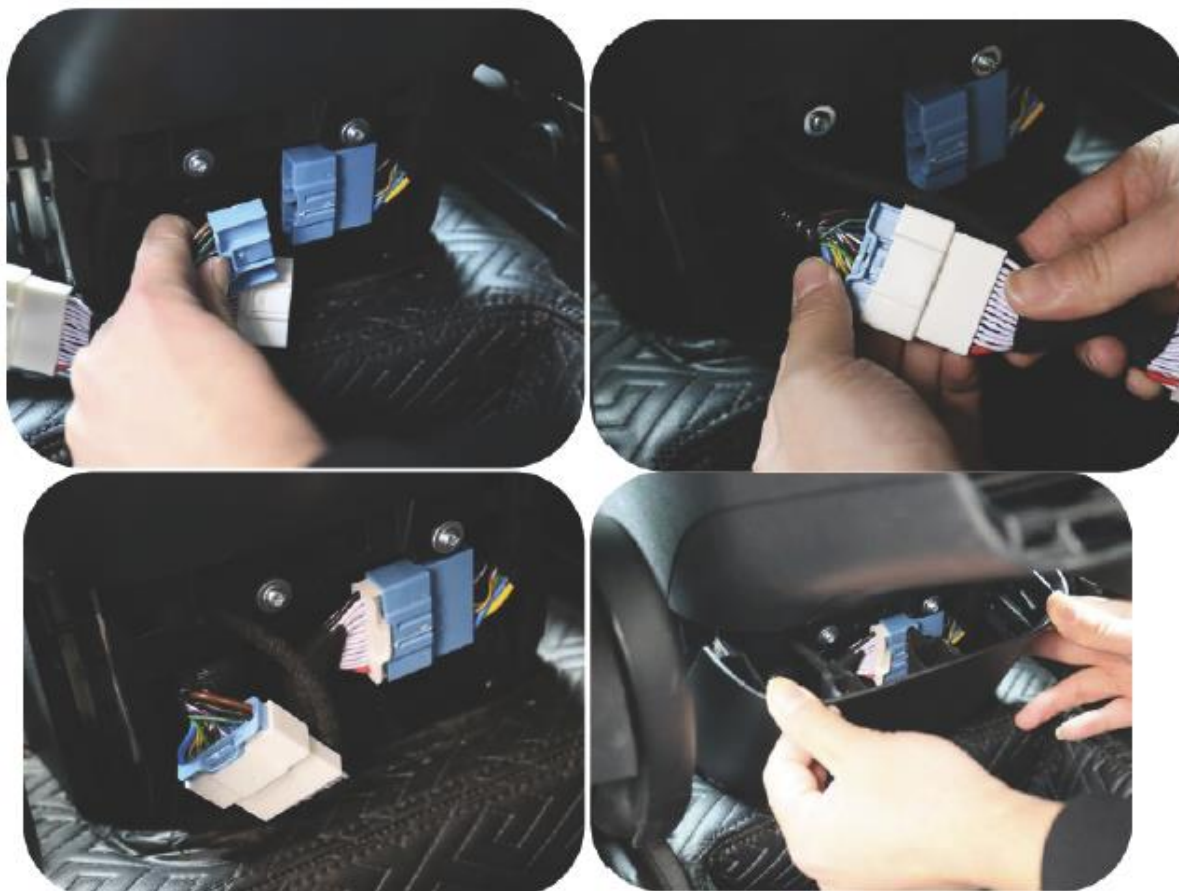
Figur 7: Her er det viktig at strømmen er avskrudd (les punkt 2.0). Ta å koble fra den blå CANbus ledningskoblingen hverandre. Deretter kobler du til den hvite CANbus adapteret i mellom slik at de hvite hurtigpluggene går i mellom de to blå.
