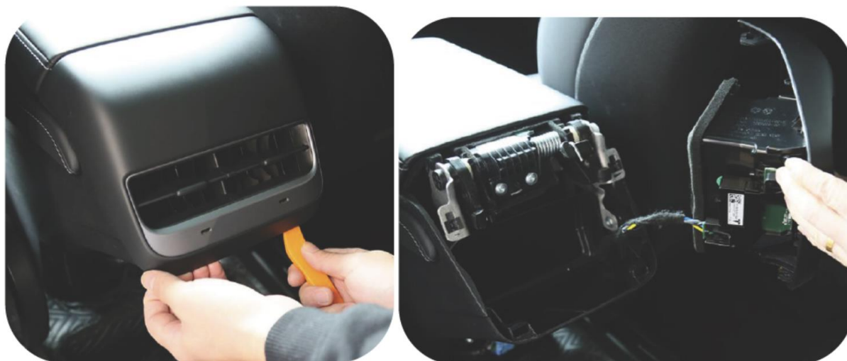
Figur 2: Bruk plastverktøyet for å løsne luftuttaket i baksete og ta det ned
