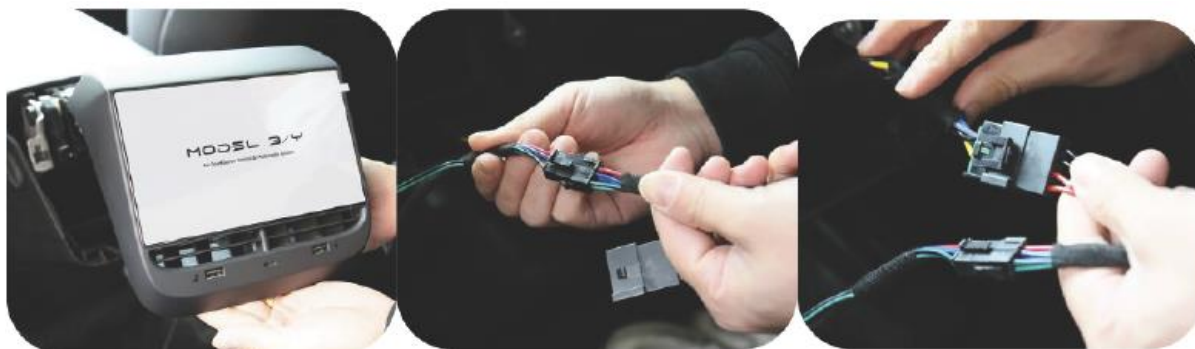
Figur 8: Ta ut selve skjermen fra pappesken og koble til strømmen til skjermen og til USB kontrolleren på skjermen.
