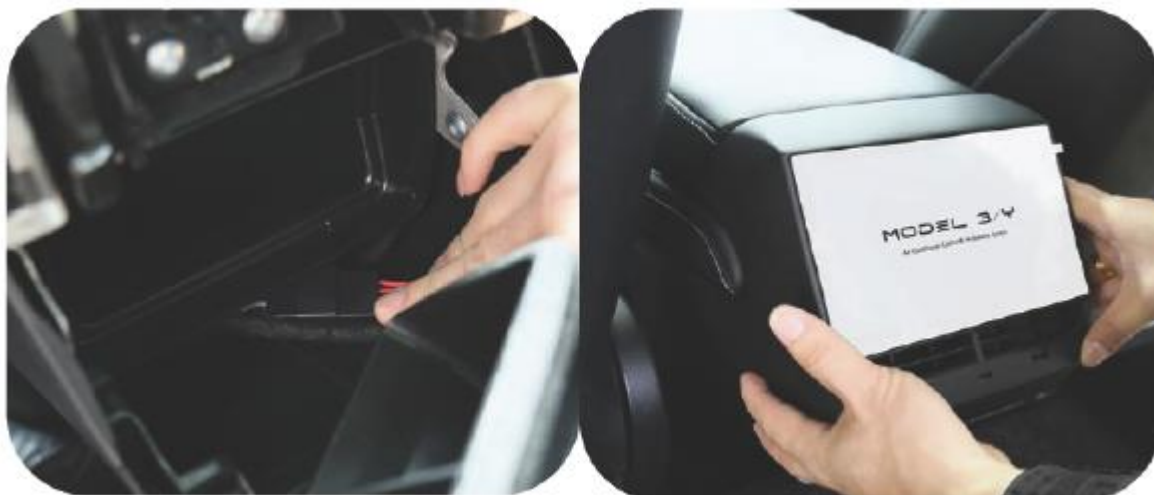
Figur 9: Plasser ledningene i rommet/gapet under ventilasjonsrøret og klikk deretter skjermen tilbake på plass.
