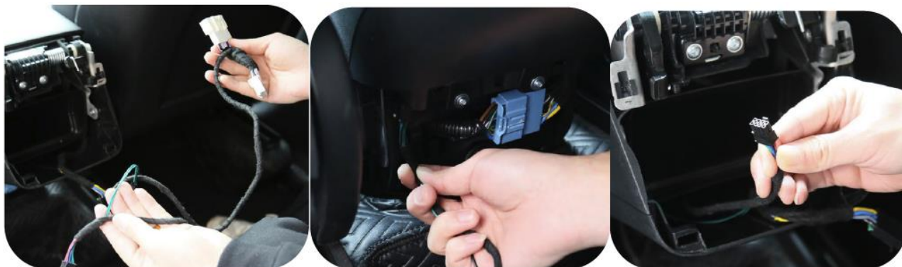
Figur 4: Ta ut ledningskoblingene med hurtigkoblinger ut fra pakken, og tre den sorte koblingen gjennom sprekken/mellomrommet nederst til venstre på luftuttaket og trekk det gjennom ut ovenfra.
