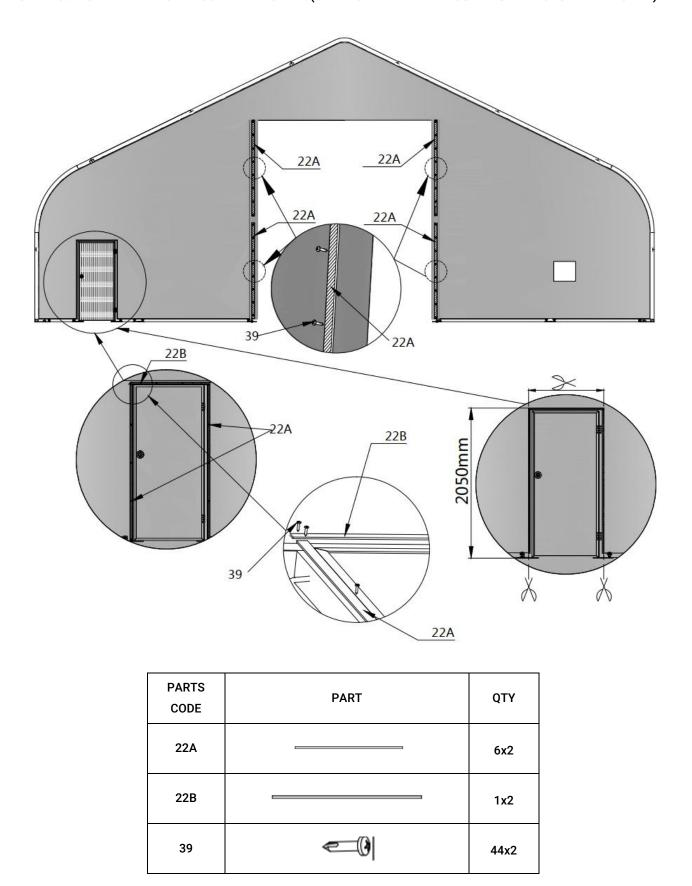
STEP 17: INSTALL THE FRONT MECHANICAL ROLLING SHUTTER DOOR.
