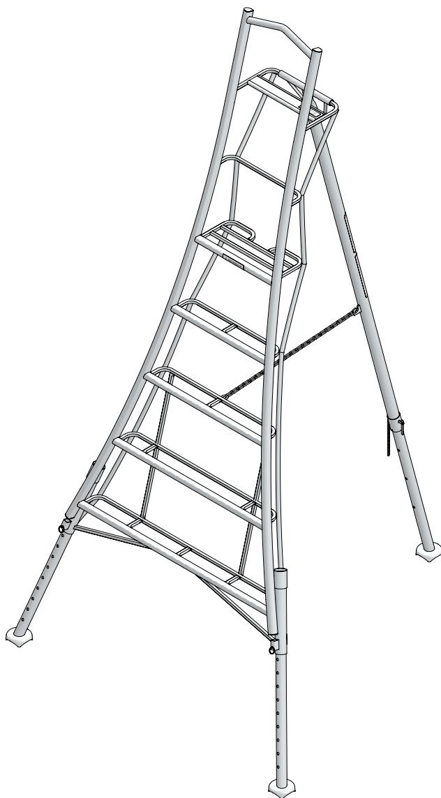
Vérifiez que les montants et les pieds ne sont pas pliés, tordus, bosselés, fissurés ou corrodés.
