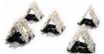
Les membranes de Lux pliées en prismes triangulaires sont des structures remarquablement solides qui conservent leur forme.
