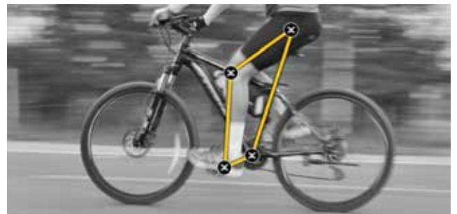
Lorsque nous faisons du vélo, nos jambes font partie d'une tringlerie à quatre barres. Les quatre barres sont la tige allant du pignon de la pédale au siège, les parties supérieure et inférieure de la jambe, et la manivelle de la pédale. Les liaisons sont les articulations de nos jambes et du vélo.
