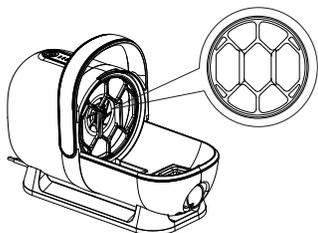
Retire el depósito de polvo y saque el filtro HEPA.
