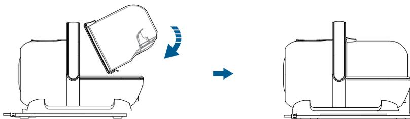
Coloque el depósito de polvo con cuidado siguiendo la dirección de la flecha.
