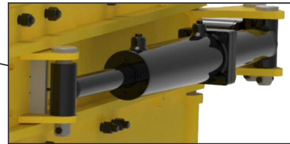
Cylindres hydrauliques de **gros diamètre** assurant une **puissance maximale**
