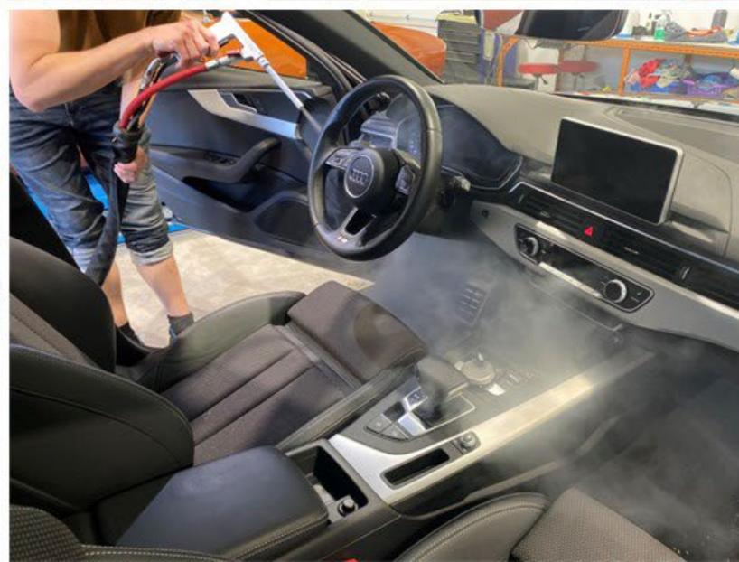
Le nettoyage cryogénique donne des résultats de nettoyage de haute qualité et de longue durée sur les machines et installations grasses et huileuses.
