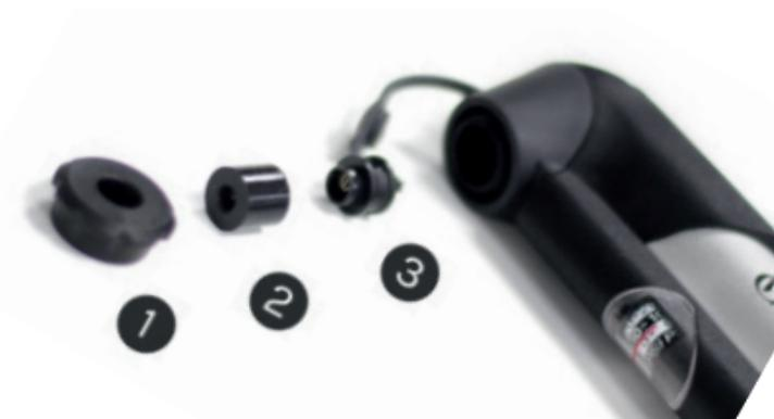
3. Para configurar Presta. Voltee las piezas individuales 180 grados 2 y 3 como se muestra en la foto de arriba, luego colóquelas nuevamente en el cabezal de la bomba. Una vez instalado, estará listo para inflar su válvula presta.
