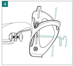
Déplacez le porte-bidon à la hauteur requise, puis serrez les boulons pour le fixer au support.
