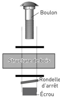
Utilisez **toujours** une rondelle d'arrêt avec chaque boulon pour éviter que ceux-ci se desserrent avec le temps.
