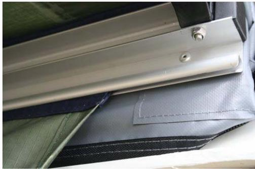
Ziehen Sie nun die Wulst des Zeltraumes in die Kederschiene des am Fahrzeug befindlichen Aluminiumprofils ein.
