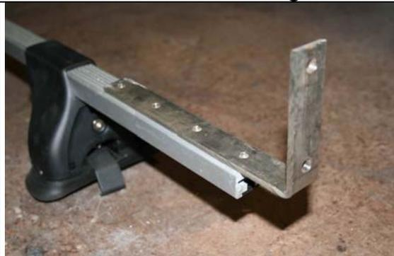
Die Höhe der montierten Markise kann durch die Position der Winkelträger verändert werden.
