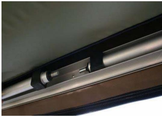
Der gesamte teleskopische Rohrrahmen ist in der Markise verstaut und mit Scharnieren befestigt. Sie fixieren und lösen die Teleskopstangen mit einer leichten Drehbewegung.
