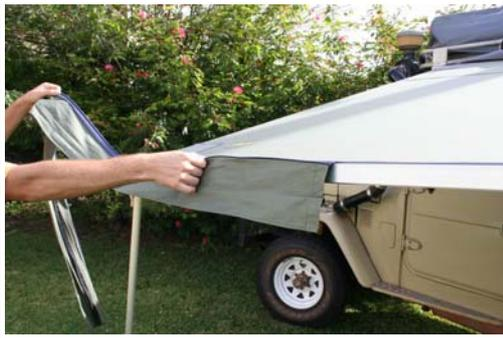
Im Lieferumfang des Zeltraumes befindet sich eine Reißverschlusskrempe. Führen Sie diese Krempe in die äußere Kederschiene der Markise ein, sie dient zur Befestigung des Moskitonetzraumes. Die Krempe kann beim Zusammenbau an der Markise verbleiben und muss nur beim ersten Aufbau eingezogen werden.
