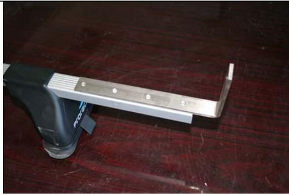
Bitte vergewissern Sie sich bei Ihrem Dachträgerhersteller, dass Bohrungen die Integrität der Querträger nicht beeinflusst. Setzen Sie den Winkelträger in gewünschter Position auf den Querträger.
