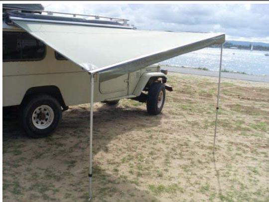
Bei Regen unterstützt das Absenken eines Markisenstandbeines den Wasserabfluss. Bitte berücksichtigen Sie dies auch wenn Sie die Markise unbeaufsichtigte lassen. Ohne ausreichenden Ablauf wird das Stauwasser die Markise beschädigen.
