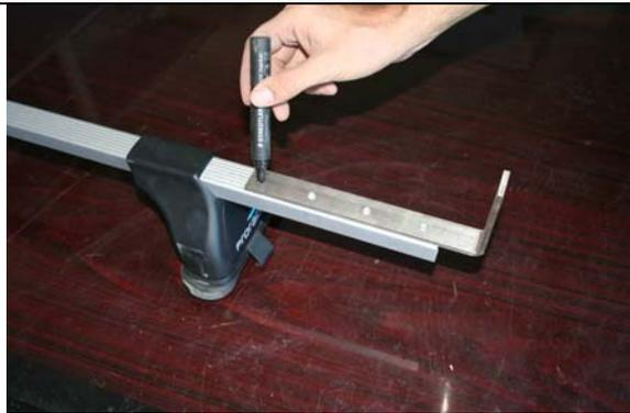
Überprüfen Sie, dass sich alle Winkelträger später am Auto auf einer Linie befinden. Markieren Sie die Position der Schrauben auf dem Träger. Benutzen Sie dazu den Winkelträger als Schablone.
