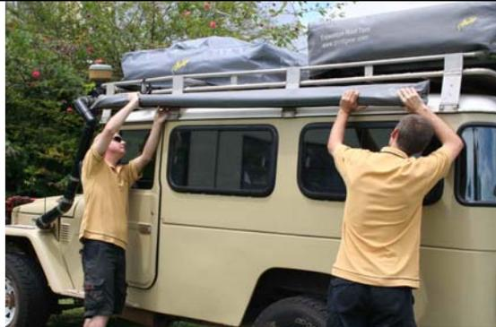
Heben Sie die Markise in Position, vergewissern Sie sich über die Ausrichtung und führen Sie die Schrauben in die vorgesehenen Löcher ein.
