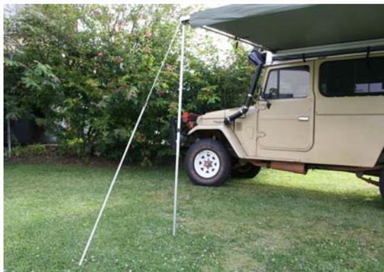
Erdnägel und Abspannseile befestigen die Markise am Boden.
