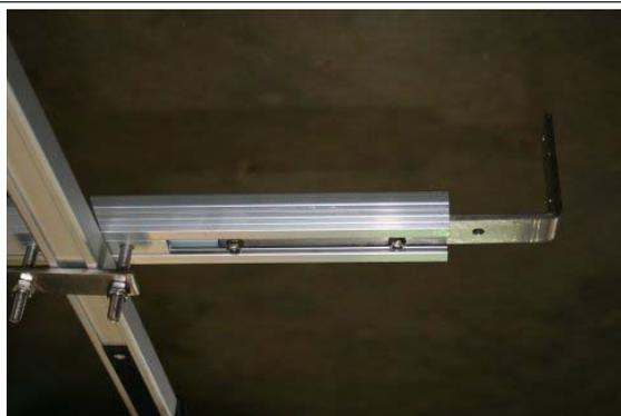
Schieben Sie die Winkelträger bis Sie die gewünschte Position erreicht haben und fixieren Sie diese mit den passenden M6 Muttern.
