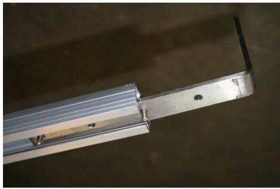
Geben Sie die M6 Schrauben in die gewünschten Löcher und führen Sie den Winkelträger in die Montierschienen des Dachzeltes ein.
