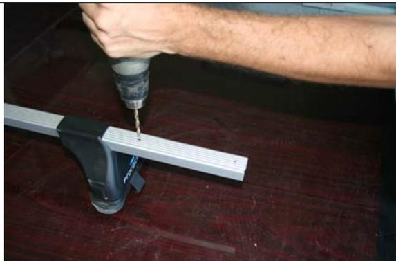
Bohren Sie nun die Löcher durch die Sie die Winkelträger befestigen. Um Beschädigungen an Ihrem Fahrzeug zu vermeiden, raten wir für diese Arbeiten die Dachträger vom Auto zu nehmen. Wir empfehlen jeden Winkelträger mit mindestens 2 M6 Schrauben zu befestigen.
