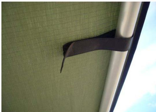
Befestigen Sie den Markisenstoff mit den Klettverschlussriemen am Rahmen.
