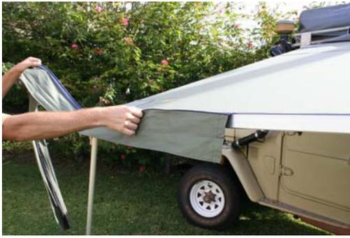
Im Lieferumfang des Moskitonetzraumes befindet sich eine Reißverschlusskrempe. Führen Sie diese Krempe in die äußere Kederschiene der Markise ein, sie dient zur Befestigung des Moskitonetzraumes. Die Krempe kann beim Zusammenbau an der Markise verbleiben und muss nur beim ersten Aufbau eingezogen werden.
