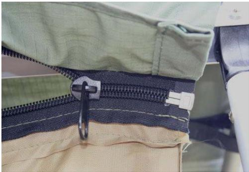
Die außenliegende Seite der Markise besitzt einen Reißverschluss. Schließen Sie diesen mit der Reißverschlusskrempe die Sie im erste Schritt eingezogen haben.
