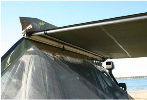
Ziehen Sie nun die Wulst des Moskitonetzraumes in die Kederschiene des am Fahrzeug befindlichen Aluminiumprofils ein.
