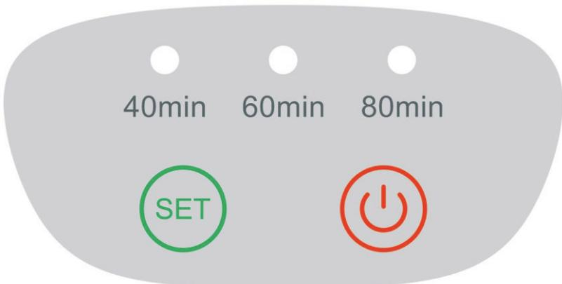
Nach dem Einschalten leuchtet standardmäßig das erste Licht, drücken Sie erneut, um das zweite Licht einzuschalten, drücken Sie ein drittes Mal, um das dritte Licht einzuschalten, drücken Sie ein viertes Mal, um alle drei Lichter gleichzeitig einzuschalten.
