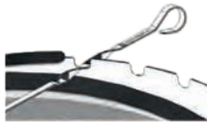
Abbildung 11: Auflage für den Spieß in der Aussparung
