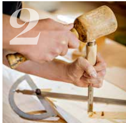
2 Mit Stemmeisen und Klüpfel wird jede Stufe auf Maß eingestemmt
