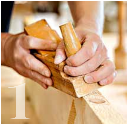
1 Per Schichthobel werden Unebenheiten des Naturmaterials ausgeglichen
