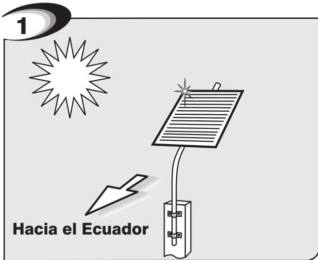
Los paneles solares deben colocarse orientados hacia la trayectoria del sol en un lugar abierto lejos de sombras. Deben recibir al menos 8 horas de luz solar directa para obtener una carga completa.
