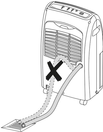
Retirez le tuyau si vous voulez de nouveau faire s'écouler les condensats dans le réservoir de récupération des condensats. Faites sécher le tuyau avant de le ranger. Il est possible de faire fonctionner l'appareil dans tous les modes avec le tuyau.
