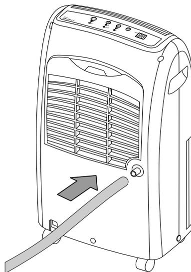
4. Vérifiez que le tuyau est bien positionné sur le raccord. Le cas échéant, corrigez la position par l'ouverture au réservoir de récupération de l'eau de condensation.
