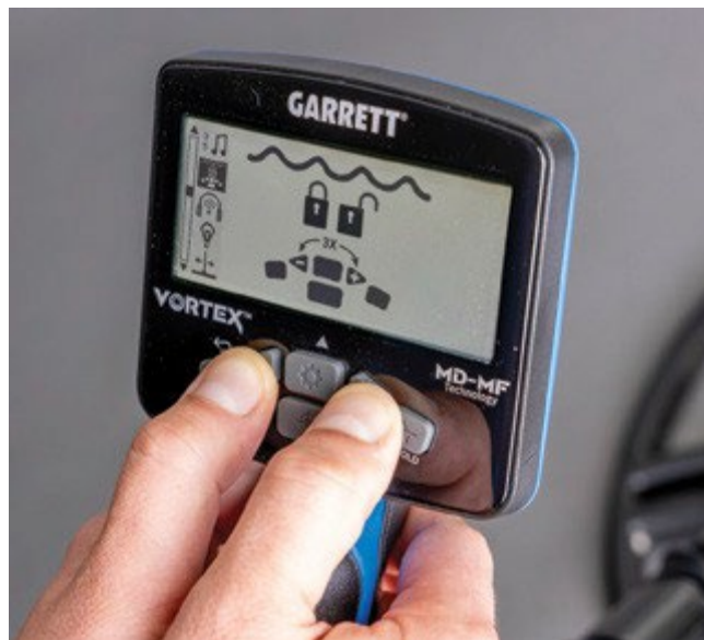
Drücken Sie die Plus (+) und Minus (-) Tasten schnell dreimal, um die Tastensperre für den Betrieb unter Wasser tiefer als 6 Fuß (2 m) zu aktivieren.
